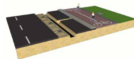
Smartroad, veibanen med kobberspolene gjennomskjært.
